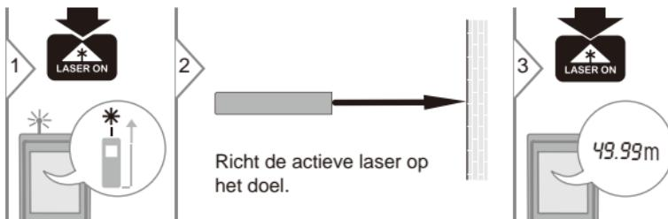
**i** Doeloppervlakken: Meetfouten kunnen optreden bij metingen van kleurlose vloeistoffen, glas, piepschuim of semi-permeabele oppervlakken of bij het richten op hoogglansoppervlakken. Op donkere oppervlakken wordt de meettijd verhoogd.
