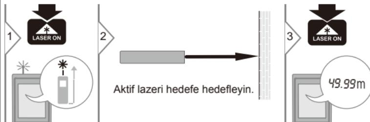
**i** Hedef yüzeyleri: Renksiz sıvılar, cam, strafor veya yarı geçirgen yüzeyler için ölçüm yapılırken ya da yüksek parlaklıktaki yüzeyleri hedef alırken ölçüm hataları oluşabilir. Ölçüm zamanı karanlık yüzeylere karşı artış gösterir.
