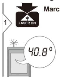
La mesure d'inclinaison est utilisée pour mesurer une pente ou une pente (par exemple des escaliers, des garde-corps, lors de l'installation de meubles, de la pose de tuyaux, etc.)
