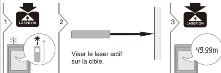
**i** Surfaces cibles : Des erreurs de mesure peuvent se produire lors de la mesure de liquides incolores, de verre, mousse de polystyrène ou de surfaces semi-perméables ou lors de la visée de surfaces très brillantes. Sur des surfaces sombres, le temps de mesure augmente.
