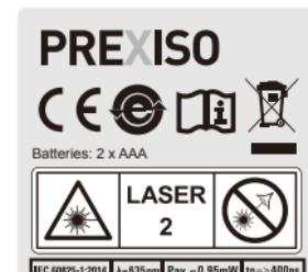
IEC 60825-1:2014  $\lambda=635\text{nm}$   $P_{av}=-0,95\text{mW}$   $t_p>>400\text{ps}$
