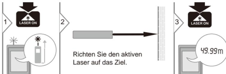
**i** Zitoberflächen: Messfehler können bei der Messung auf farblosen Flüssigkeiten, Glas, Styropor oder semipermeablen Oberflächen oder auf hochglänzenden Oberflächen auftreten. Bei dunklen Oberflächen erhöht sich die Messzeit.
