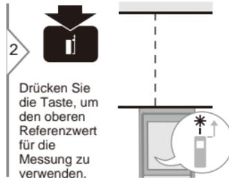
Drücken Sie die Taste, um den oberen Referenzwert für die Messung zu verwenden.
