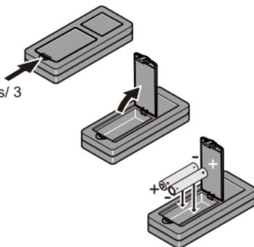
Changez les batteries lorsque l'icône de la batterie est vide.
